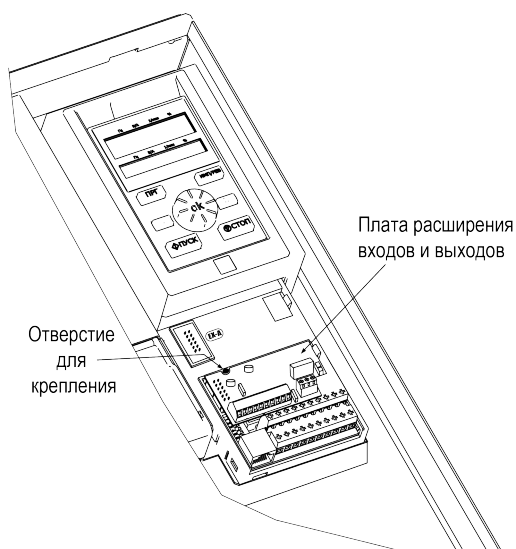
Рисунок 7.19 – Монтаж платы расширения входов и выходов
