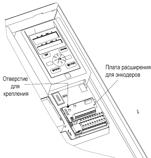
Рисунок 7.20 – Монтаж платы расширения для энкодеров
